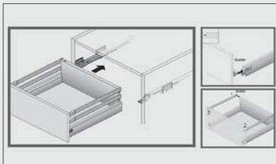
۷. درب کشو را مطابق شکل زیر ریگلاژ نمایید و سپس پیچ فیکس تنظیم را محکم نمایید. با باز و بسته کردن میله گالری درب را بسمت داخل یا بیرون میتوانید ریگلاژ کنید و در انتها کاور را بصورت کشویی جا بزنید.
