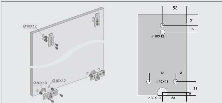
۳. درب را به صورت زیر روی یونیت سوار کنید و سپس ریگلاز نمایید..
